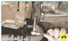
Рис. 5.18. Порядок выворачивания болтов крепления крышки масляного картера двигателя
