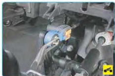
16. Сожмите пассатижами ушки фиксатора наконечника троса выбора передач...
