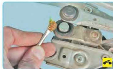
11. Нанесите на палец консистентную смазку...
