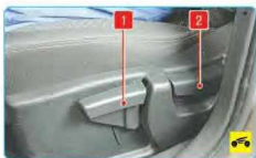
Рис. 1.18. Рычаги регулировки положения сиденья: 1 – рычаг регулировки высоты подушки сиденья; 2 – рычаг регулировки угла наклона спинки
