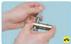
28. Измерьте наружный диаметр поршневого пальца.
