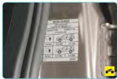
Наклейка со значениями давления воздуха в шинах расположена на центральной стойке автомобиля со стороны водителя.
