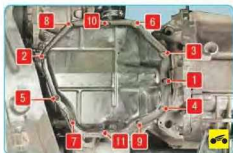
Рис. 5.18. Порядок выворачивания болтов крепления крышки масляного картера двигателя
