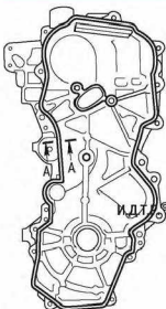
Рис. 5.9. Последовательность затяжки болтов крепления крышки газораспределительного механизма
