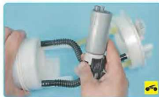
34. Извлеките топливный насос из корпуса модуля.
