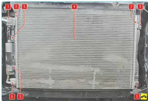
Рис. 12.4. Конденсор кондиционера: 1 – фланец крепления трубопроводов линии высокого давления 2 – бачок конденсора; 3 – кронштейн крепления конденсора; 4 – соты; 5 – фланец крепления трубопроводов ресивера
