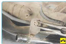
10. Сожмите концы пластмассового держателя и извлеките его из кронштейна воздухоотводящей трубки.
