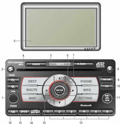
Рис. 1.15. Головное устройство с системой навигации: 1 – выключатель электропитания аудиосистемы/регулятор громкости; 2 – клавиша загрузки CD; 3 – цветной дисплей центральной консоли; 4 – проем для загрузки CD; 5 – клавиша возврата «BACK»; 6 – клавиша подтверждения выбора; 7 – вращающийся переключатель для прокрутки меню; 8 – клавиша извлечения компакт-диска; 9 – клавиша переключения диапазонов FM/AM приемника; 10 – клавиша включения режима воспроизведения CD; 11 – клавиша поиска радиостанций в режиме радиоприемника/переход к следующей записи; 12 – клавиша выбора заранее запрограммированных радиостанций радиоприемника/клавиша выбора компакт-диска в режиме CD-проигрывателя; 13 – клавишу управления вверх-вниз, влево-вправо; 14 – клавиша вызова перечня радиостанций в режиме радиоприемника/клавиша «МIX»; воспроизведение CD в случайном порядке/«RPT»; повторное воспроизведение CD; 15 – клавиша выбора типа радиопрограммы «PTY»; 16 – клавиша приема дорожных сообщений «TA»
