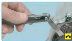
22. Измерьте плоским щупом зазор между поверхностями трения прижимной пластины и шкива. Если зазор неодинаков в разных точках окружности, значит, прижимная пластина деформирована и подлежит замене. Номинальный зазор составляет 0,25–0,45 мм.
