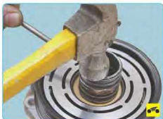
19. Напрессуйте шкив на переднюю крышку компрессора. При напрессовке прилагайте усилие только к внутренней обойме подшипника.
