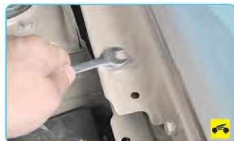
9. Выверните болты В (см. примечание) верхнего крепления крыла к кузову.
