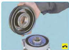
13. Спрессуйте шкив с посадочной шейки передней крышки компрессора.
