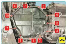
Рис. 5.19. Порядок вворачивания болтов крепления крышки масляного картера двигателя
