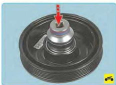
17. Запрессуйте новый подшипник. При запрессовке прилагайте усилие только к наружной обойме подшипника.
