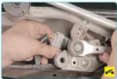
6. Нажмите на фиксатор колодки жгута проводов стеклоочистителя...
