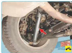
3. Осмотрите амортизаторы, на амортизаторах не допускаются потоки жидкости и запотевание.
