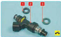
Рис. 5.23. Элементы топливной форсунки: 1 – верхнее уплотнительное кольцо; 2 – форсунка; 3 – уплотнительное кольцо со стороны распылителя
