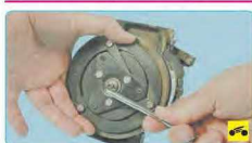
21. Наденьте на вал прижимную пластину и вверните болт крепления пластины.
