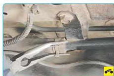
11. Сожмите ушки хомута крепления шланга к воздухоотводящей трубке, сдвиньте хомут по шлангу...
