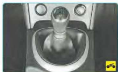
Рис. 1.20. Рычаг селектора управления вариатором: 1 – шкала ручного режима; 2 – шкала автоматического режима управления; 3 – рукоятка рычага
