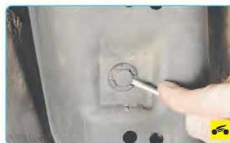
6. Подденьте отверткой верхний фиксатор держателя кожуха наливной трубы...
