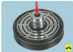
16. С помощью оправки подходящего диаметра выпрессуйте старый подшипник из шкива.
