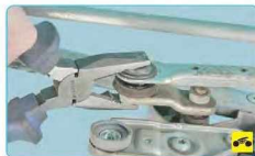
12. ...и установите шарнир на палец пассажирами до защелкивания на пальце фиксатора.
