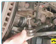
5. Разогните усики шплинта гайки ступицы...
