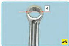
27. Измерьте внутренний диаметр d втулки верхней головки шатуна.
