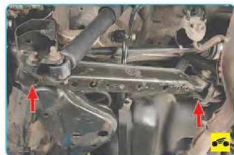
5. С помощью монтажной лопатки проверьте на отсутствие люфтов сайлентблоки задних нижних рычагов (для наглядности показано на снятом заднем нижнем рычаге)...
