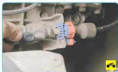
13. Отожмите фиксатор наконечника оболочки троса выбора передач...
