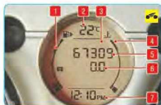
Рис. 1.12. Жидкокристаллический дисплей: 1 – указатель уровня топлива; 2 – указатель температуры наружного воздуха; 3 – зона индикатора положения селектора вариатора (для автомобиля с вариатором); 4 – указатель температуры охлаждающей жидкости; 5 – одометр; 6 – счетчик суточного пробега/бортовой компьютер (для некоторых комплектаций); 7 – цифровые часы (для автомобилей без навигационной системы)
