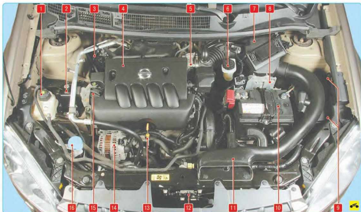
Рис. 1.3. Подкапотное пространство автомобиля с двигателем MR 20DE 2,0 л (вид сверху, с установленным декоративным кожухом): 1 – расширительный бачок; 2 – правая опора подвески силового агрегата; 3 – гидроэлектронный модуль ABS; 4 – декоративный кожух двигателя; 5 – дроссельный узел; 6 – бачок главного тормозного цилиндра и гидропривода выключения сцепления; 7 – корпус воздушного фильтра; 8 – электронный блок управления двигателем; 9 – монтажные блоки реле и предохранителей; 10 – аккумуляторная батарея; 11 – воздухозаборник с резонатором входящего воздуха; 12 – замок капота; 13 – указатель уровня масла (маслоизмерительный щуп); 14 – генератор; 15 – пробка масляной горловины; 16 – наливная горловина бачка омывателя
