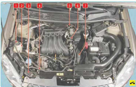
Рис. 5.21. Расположение элементов системы охлаждения: 1 – крышка расширительного бачка; 2 – расширительный бачок; 3 – верхняя рамка радиатора; 4 – лароотводящий шланг; 5 – шланги отопителя; 6 – шланги подогрева дроссельного узла; 7 – подводящий шланг радиатора
