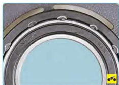
15. Срезьте на токарном станке завальцовки, фиксирующие подшипник в шкиве.
