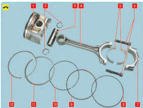
Рис. 5.12. Детали шатуно-поршневой группы: 1 – поршни; 2 – стопорные кольца поршневого пальца; 3 – поршневой палец; 4 – шатун; 5 – вкладыши; 6 – болты крепления крышки шатуна; 7 – крышка шатуна; 8 – нижнее маслосъемное кольцо; 9 – расширитель маслосъемных колец; 10 – верхнее маслосъемное кольцо; 11 – нижнее компрессионное кольцо; 12 – верхнее компрессионное кольцо
