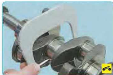
24. Измерьте микрометром диаметр D н коренных шеек коленчатого вала. Фактический зазор между вкладышами коренных
