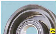
18. Зафиксируйте подшипник кернением края посадочного отверстия шкива.
