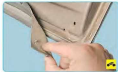
2. ...и, преодолевая сопротивление фиксатора, отсоедините его от панели двери.
