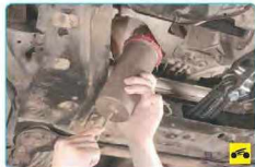
Рис. 6.10. Раздаточная коробка: 1 – фланец выходного вала раздаточной коробки; 2 – пыльник салника выходного вала; 3 – корпус раздаточной коробки; 4 – пробка сливного отверстия; 5 – фланец крепления раздаточной коробки; 6 – пробка контрольного (наливного) отверстия; 7 – салун раздаточной коробки; 8 – ведущий вал раздаточной коробки; 9 – салник ведущего вала раздаточной коробки; 10 – уплотнительное кольцо
