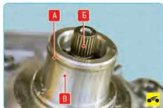
14. Осмотрите шлицы и наконечника вала, канавку А для стопорного кольца и посадочную поверхность В шейки подшипника (для надежности кагушка магнита снята). При их износе или повреждении компрессор подлежит замене.
