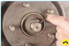
6. ...и извлеките шплинт из отверстия оси поворотного кулака.
