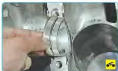
Рис. 5.15. Расположение замков поршневых колец перед установкой поршня в цилиндр: 1 – замок расширителя масляного кольца и верхнего компрессионного кольца; 2 – замок верхнего кольца составного масляного кольца; 3 – замок нижнего компрессионного кольца; 4 – замок нижнего кольца составного масляного кольца
