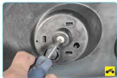
14. При замене бампера выверните винт крепления отражателя...
