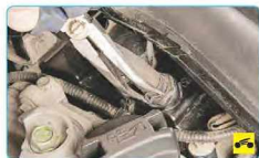
Рис. 5.19. Порядок вворачивания болтов крепления крышки масляного картера двигателя
