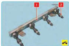
Рис. 5.22. Топливная рампа с форсунками: 1 – рампа; 2 – форсунка
