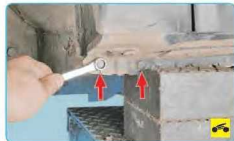
12. ...и два болта нижнего крепления крыла к порту кузова.
