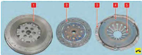
Рис. 6.1. Сцепление: 1 – маховик двигателя; 2 – ведомый диск; 3 – кожух сцепления; 4 – нажимной диск; 5 – диафрагменная пружина
