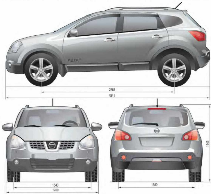
Рис. 1.2. Габаритные размеры (мм) автомобиля Nissan Qashqai+2
