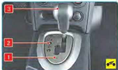
Рис. 1.20. Рычаг селектора управления вариатором: 1 – шкала ручного режима; 2 – шкала автоматического режима управления; 3 – рукоятка рычага
