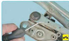
9. Если в процессе работы стеклоочистителя наблюдались заедания или скрип шарниров трапеции, подденьте отверткой шарнир тяги...
