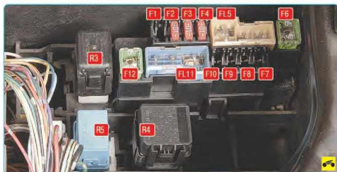
Рис. 10.2. Номера предохранителей и реле в переднем монтажном блоке, расположенном в моторном отсеке
