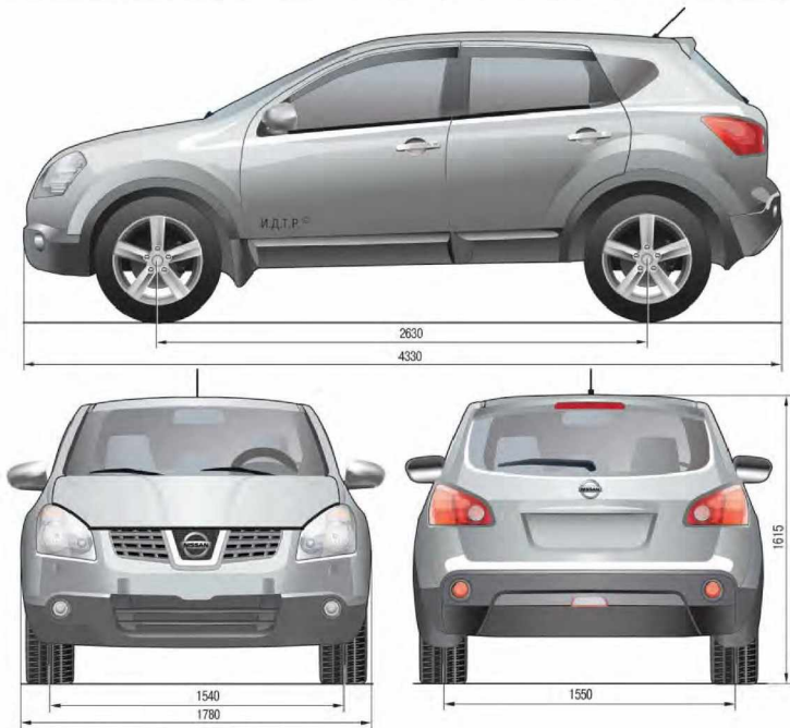
Рис. 1.1. Габаритные размеры (мм) автомобиля Nissan Qashqai
