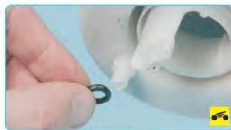
35. Снимите уплотнительное кольцо с корпуса модуля топливного насоса и замените его.
