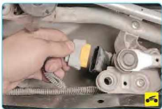
7. ...отсоедините колодку от выводов моторедуктора стеклоочистителя...
