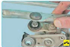
10. ...и снимите шарнир с пальца кривошипа, преодолевая упругое сопротивление пружинного фиксатора.
